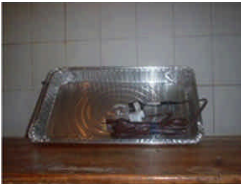
Foto N° 5 Bandeja térmica para ser usada en los días que hay mucha humedad en el ambiente para evitar que laca se torne opaca
