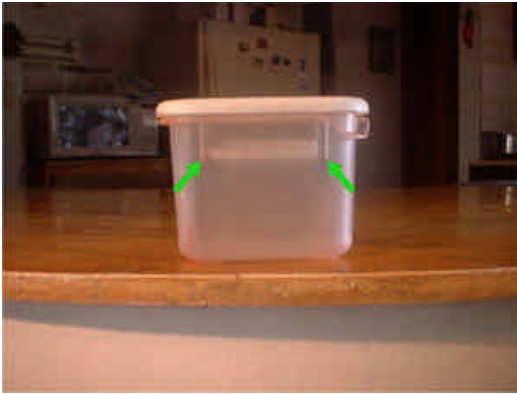
Foto N°. 3 Cubito del teñidor, flechas verdes indican topes que impiden el deslizamiento de los cubitos en la parrilla. Fabricado en Brasil por la fábrica Plasútil. Ref. 769
