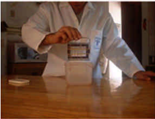
Foto N°. 4 El cubito del teñidor tiene capacidad de 440 MI, cabe una canastilla de 30 plaquitas. Las plaquitas se tiñen en posición vertical con la parte esmerilada hacia arriba y se sujetan con ligas
